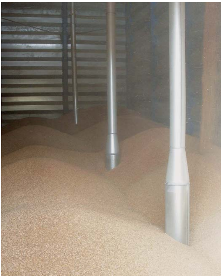
Рис. 2: Монтаж трёх AIR-Pillar труб
