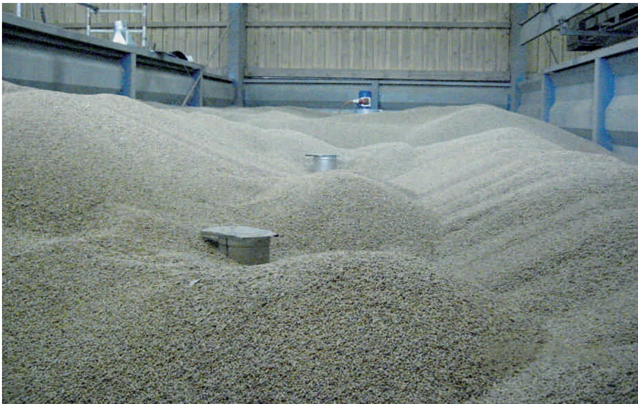
Zdjęcie 4 Powierzchnia zasypu po napełnieniu magazynu Powierzchnia nasypu nie jest zrówna, AIR-Pillar z przodu i w środku zamknięta przykrywą, z tyłu nałożony wentylator)
