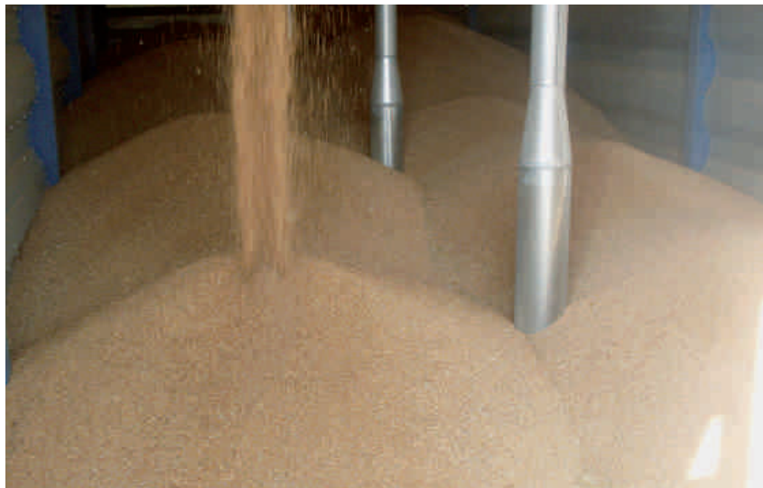
Zdjęcie 3 Załadowanie magazynu Zasyp znajduje się na ca. średniej wysokości rury
