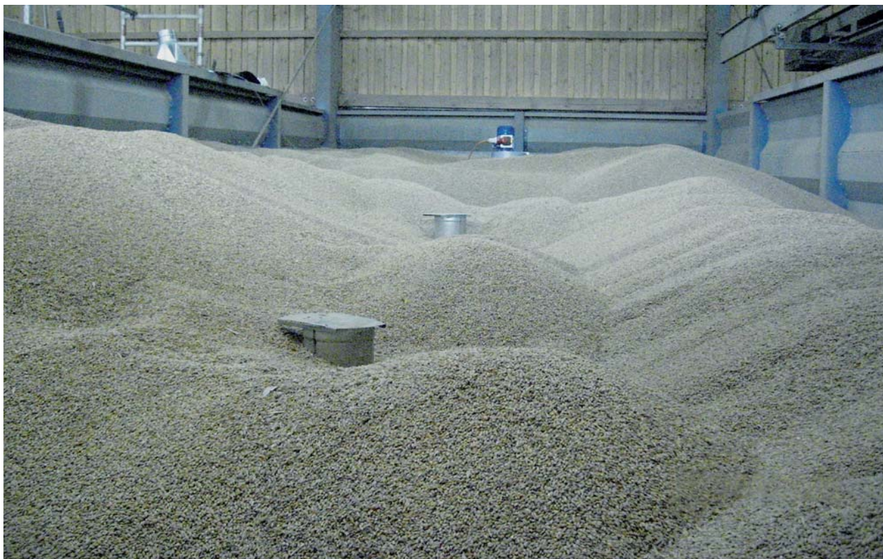
Figure 4 : surface du produit déversé après le remplissage du compartiment de stockage La surface du produit déversé n'est ici pas encore nivelée, tube AIR-Pillar à l'avant et au milieu fermé par une « tôle de recouvrement » (à l'avenir, couvercle en plastique), à l'arrière avec ventilateur installé)
