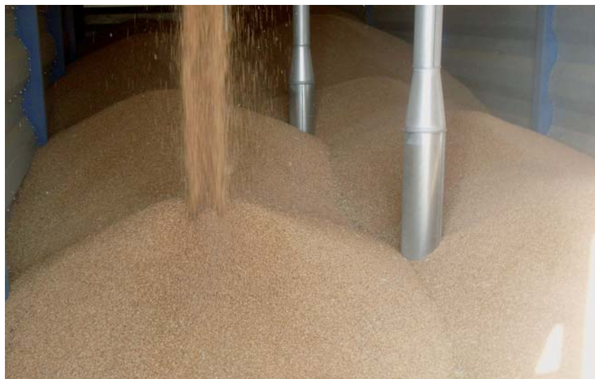
Figure 3 : remplissage du compartiment de stockage (Le produit déversé se trouve env. à la hauteur moyenne du tube d'aspiration.)
